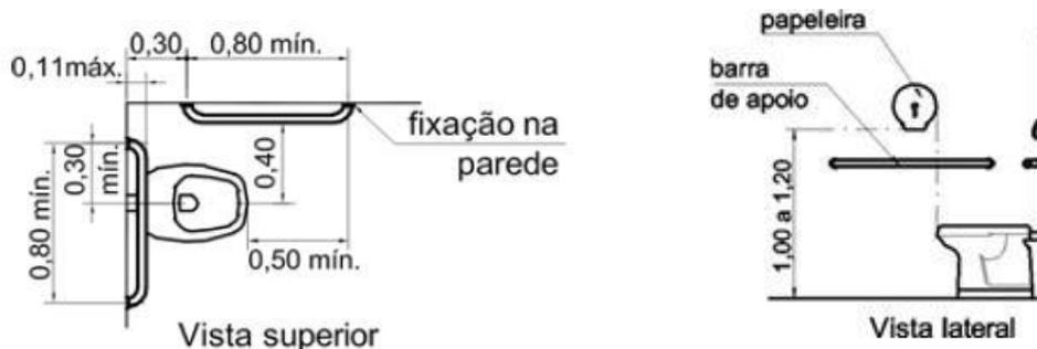
Figura 15: Posição das barras de apoio junto às bacias sanitárias
