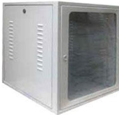
Mini Rack de parede altura 6U, padrão 19", estrutura em aço e porta com visor em acrílico ou vidro, com chave, profundidade mínima de 450mm.
