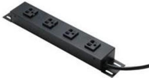
Régua de tomada com 4 posições, altura 1U, para rack padrão 19", confeccionada em aço, tensão 110/220V com cabo de alimentação de no mínimo 1,5m.
