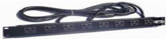
Régua de tomada com 8 posições, altura 1U, para rack padrão 19", confeccionada em aço, tensão 110/220V com cabo de alimentação de no mínimo 1,5m.
