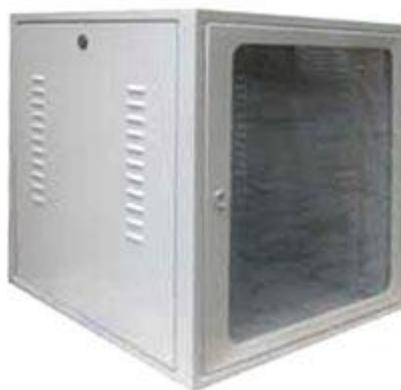
Mini Rack de parede, padrão 19", altura 12U, estrutura em aço e porta com visor em acrílico ou vidro, com chave, profundidade mínima de 450mm.
